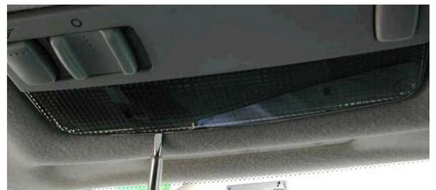
Die Lampe wird einmal durch zwei Kreuzschrauben (siehe voriger Bild) gehalten und durch eine Art Plastiklasche. Schrauben raus, und dann mit einer flachen Klinge die Lampe zwischen Gehäuse und Himmel abwechselnd links, rechts, vorne und hinten aushebeln. Dann muss nur noch der Anschlussstecker abgezogen werden.
