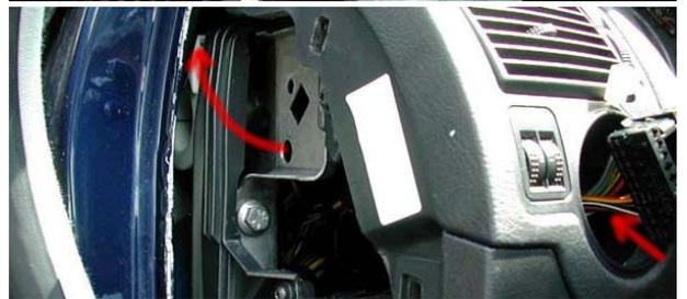
Nun, da man alle vier benötigten Kabel beisammen hat, müssen die zum Gehäuse (3B0972706) passenden „Kabelschuhe“ (000979131A) an das neu verlegte Kabel sowie an die drei vorhandenen angebaut werden. Am leichtesten ist es, wenn man die alten Kabel direkt am Stecker (oder kurz davor, wenn man evtl. mal rückrüsten möchte) abknipst, die neuen „Kabelschuhe“ dran baut (bei mir mit Hilfe von Lüsterklemmen) und gleich in das Gehäuse steckt.
