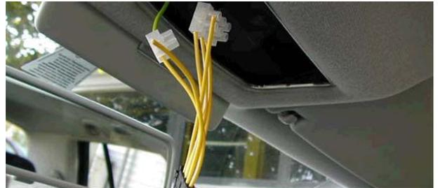
Die neue Leuchte wird eingeklipst und braucht nicht verschraubt zu werden. Bevor man die Leuchte in Position bringt, sollte in der Ecke wo jetzt der Stecker sitzt, der Dämmstoff etwas rausgeschnitten werden, damit genug Platz vorhanden ist. Ich habe einfach mit einem Messer mehrmals hineingestochen, und dann mit den Fingern das Dämm-Material herausgeholt.
