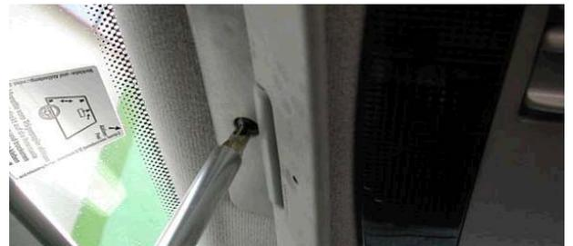
Die vorhandene Leuchte muss erst mal raus, was folgendermaßen funktioniert: mit einem flachen Schraubenzieher (oder guten Fingernägeln \*g\*) die „Glasabdeckung“ aushebeln, dann die Lämpchen entfernen (wegen Erschütterungen - die kann man immer noch als Ersatzlampen brauchen), die Leseleuchten sind nur gesteckt, die Sofitten-Birne kann nach Wegbiegen der Fassung auch ganz leicht entnommen werden.
