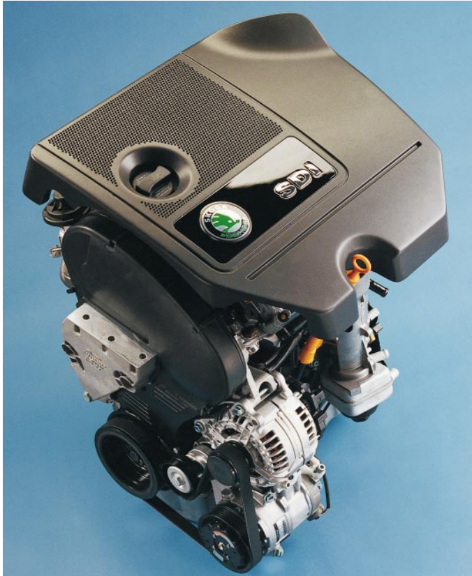
Bild 21: 1,9-l-SDI-Dieselmotor mit 47 kW
